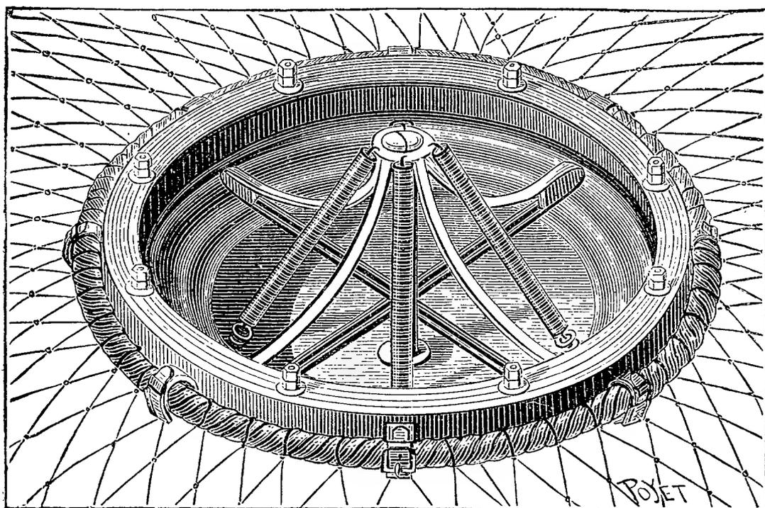
Fig. 3. — Soupape à ressorts métalliques.
